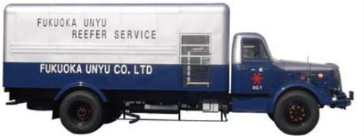
国産第一号機械式冷凍車(矢野式冷凍車)
